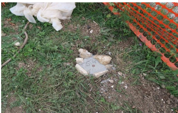
Figura 5. Il caposaldo ST 4 , posto su chiodo topografico fissato su plinto in cemento
